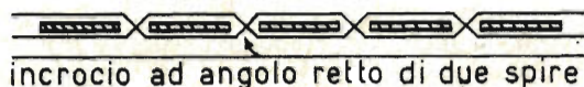
Fig. 4 - Nella successione di due spire consecutive il filo si incrocia ad angolo retto, da una parte e dall'altra delle alette.
